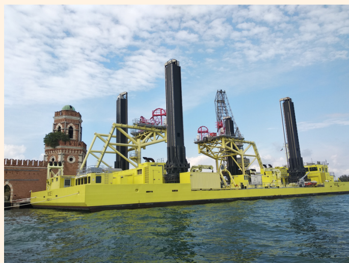
Il jack up per la movimentazione delle paratoie
