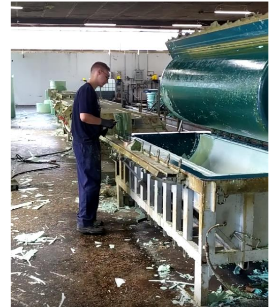
Impianto schiumatura di poliuretano
